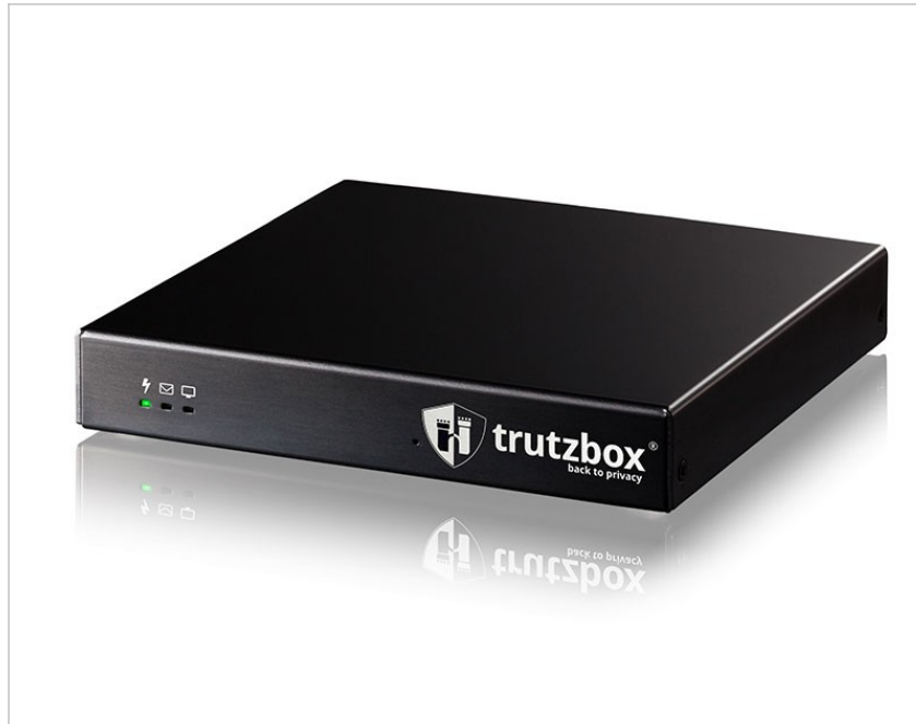
Abbildung 2-1: Die TrutzBox von vorn. Links die drei LEDs für Betrieb, TrutzMail und geblockte Verbindungen. (© 2026 Comidio GmbH)
