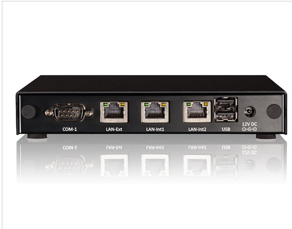
Abbildung 2-2: Die Rückseite mit ihren beschrifteten Anschlüssen. LAN-Ext zeigt zum Internet-Router, LAN-Int1 und LAN-Int2 zu Ihren eigenen Geräten. (© 2026 Comidio GmbH)
